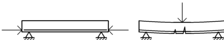
Рис. 3.3. Предварительно напряженная балка на двух опорах – без нагрузки и под нагрузкой.
